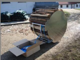
Durch das Verschieben oder Entfernen der Alu-Anschlagwand ist es möglich, verschiedene Längen von 50 cm bis 1 m lange Hölzer zu bündeln.
